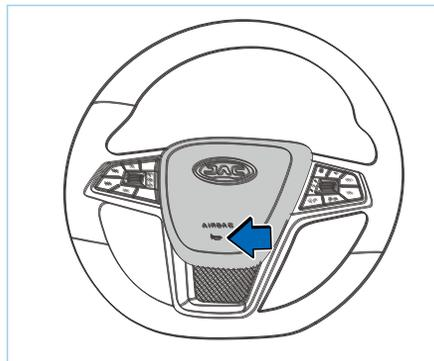
Нажмите выключатель звукового сигнала на рулевом колесе, и будет издаваться звуковой сигнал.
