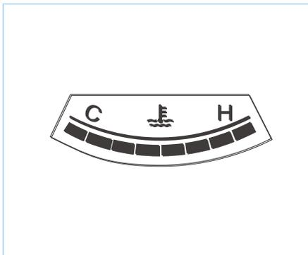
Водный термометр показывает температуру охлаждающей жидкости двигателя при включении зажигания. Верхний предел температуры воды обозначен как Н, а нижний предел обозначен как С. Когда пусковой выключатель находится в положении ON, водяной термометр показывает температуру охлаждающей жидкости двигателя. Водный термометр отображает восемь сеток. Количество ярких сеток показывает уровень температуры охлаждающей жидкости двигателя.
