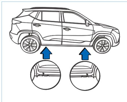
При использовании домкрата для подъема автомобиля проверьте его положение несколько раз, чтобы предотвратить падение автомобиля.
