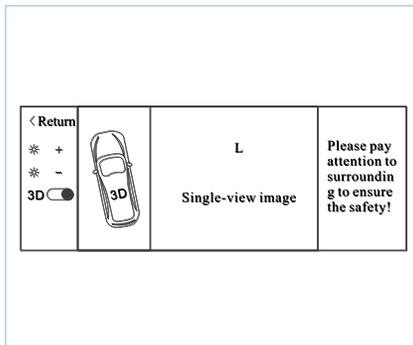
Когда отображается 3D-панорамный дисплей, поверните левый поворотный переключатель, чтобы переключиться на 3D-панорамный дисплей с левым обзором и одноканальное левое видеоизображение. Когда сигнал переключателя левого поворота пропадает, экран возвращается к предыдущему трехмерному панорамному дисплею.
