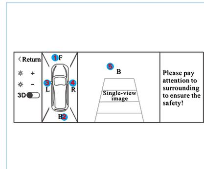
Когда интерфейс дисплея разделен, панорамный экран находится с левой стороны, а одноканальный видеодисплей находится с правой стороны, вы можете нажать область 1, чтобы переключиться на «отображение экрана переднего вида». Когда интерфейс дисплея разделен, панорамный экран находится с левой стороны, а одноканальный видеодисплей находится с правой стороны, его можно переключить на «отображение экрана заднего вида» выше, нажав область 2 или выбрав R снаряжение.
