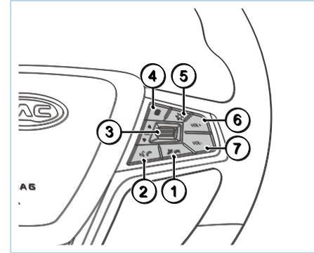
1. Функция телефона доступна только для моделей, оснащенных телефонами Bluetooth и системами распознавания голоса. Если эта функция включена, нажмите эту кнопку, чтобы выключить голосовую систему; на телефоне с Bluetooth и во время разговора нажмите эту клавишу, чтобы завершить вызов или отклонить вызов. Нажмите эту кнопку, чтобы отключить звук во время работы информационно-развлекательной системы.
