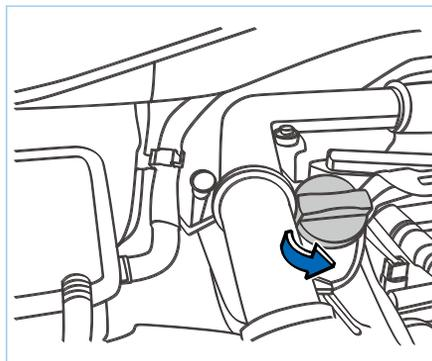
Если уровень моторного масла близок или ниже самой низкой точки, моторное масло следует доливать вовремя. Уровень масла ни при каких обстоятельствах не должен превышать отметку на щупе. В противном случае масло будет вдыхаться в систему впуска воздуха через вентиляционное отверстие коленчатого вала и выбрасываться в воздух через выхлопную систему. Моторное масло может сгореть в каталитическом очистителе и повредить его. После доливки осторожно закройте крышку заправочной горловины и
