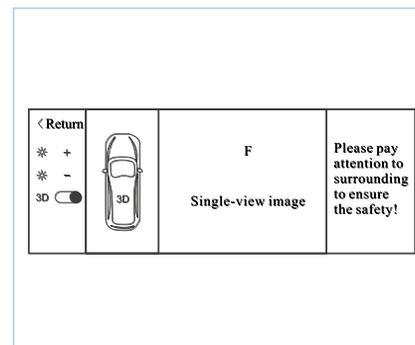
Когда интерфейс дисплея разделен, панорамный экран находится с левой стороны, а одноканальный видеодисплей находится с правой стороны, вы можете нажать кнопку «2D / 3D», чтобы переключиться на экран 3D-дисплея: левая сторона 3D-видео дисплея, а правая сторона - одноканальный видео дисплей.
