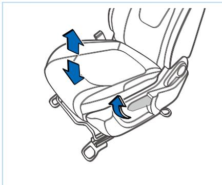
Водительское кресло имеет ручку регулировки высоты, которая находится за пределами сиденья. Этапы регулировки сиденья по высоте: переместите ручку регулировки высоты вверх или вниз и отрегулируйте высоту сиденья в желаемое положение.
