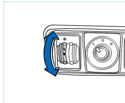
Дальность освещения ближнего света можно отрегулировать в кабине, а переключатель регулировки расположен на панели переключателей на приборе с левой стороны рулевого колеса. Расстояние освещения ближнего света можно отрегулировать, отрегулировав переключатель, чтобы приспособиться к разному наклону автомобиля, вызванному разной массой автомобиля. По мере увеличения положения передачи дальность освещения ближнего света уменьшается.
