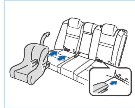
3. Вставьте механизм блокировки детского кресла в нижнюю фиксированную точку, чтобы убедиться, что два механизма блокировки ISOFIX зафиксированы надлежащим образом.
