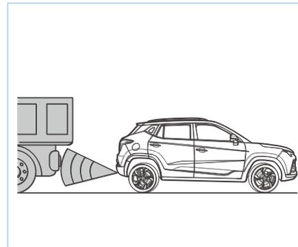
Датчик радара заднего хода не может обнаружить автомобиль с высоким шасси.
