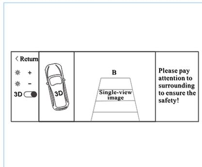
Когда отображается трехмерный панорамный дисплей и рычаг переключения передач переведен на заднюю передачу, потяните левый поворотный переключатель, чтобы переключить экран на трехмерный панорамный дисплей левого заднего вида и одноканальное видеоизображение заднего вида плюс статическая вспомогательная линия для движения задним ходом, и автомобиль начнет движение вперед. Когда передача заднего хода отключена, экран возвращается к предыдущему трехмерному панорамному изображению.
