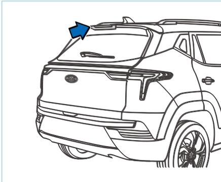
Лампа верхнего стоп-сигнала используется для дополнения индикации и предупреждения стоп-сигнала.
