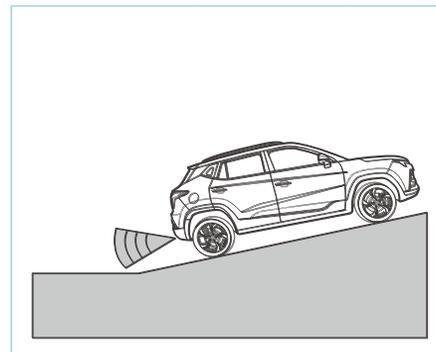
Если автомобиль движется по крутому склону, может возникнуть сбой в работе радарной системы заднего хода.
