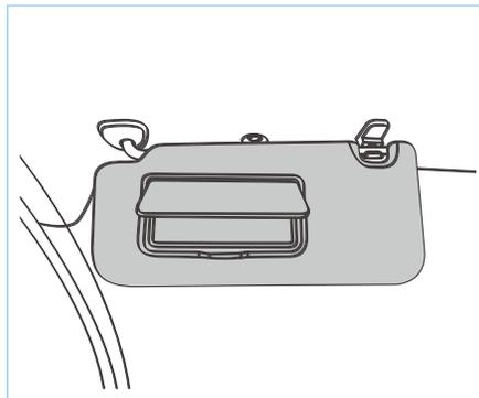
Чтобы защитить от переднего и бокового солнечного света водителя и пассажира на передних сиденьях, перед сиденьями водителя и пассажира оборудованы два солнцезащитных козырька. Откиньте конец солнцезащитного козырька, чтобы открыть солнцезащитный козырек, и удерживайте его в желаемом положении. Верните его в исходное положение, если солнцезащитный козырек не используется.
