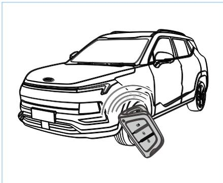
С пультом дистанционного управления на ключе некоторые функции могут быть реализованы без использования механического ключа, например, блокировка, разблокировка поиска автомобиля, разблокировка багажника, регулировка окон и т.д.
