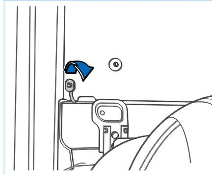
3. Медленно поверните крышку топливного бака против часовой стрелки. Если вы слышите «шипение» (звук выброса топливного пара), дождитесь, пока звук прекратится, затем отвинтите крышку топливного бака и поместите ее на кронштейн внутри крышки топливного бака.
