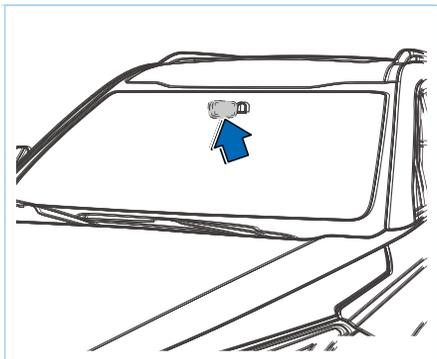
Окошко под VIN-номер автомобиля расположено горизонтально по центру и вертикально в верхней части лобового стекла.
