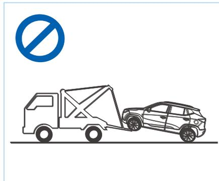
Запрещается использовать подъемную тележку для буксировки, иначе можно повредить кузов.
