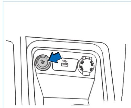
Нажмите кнопку в верхней части прикуривателя и извлеките прикуриватель после того, как кнопка прикуривателя выскочит вверх автоматически. Заignite сигарету с помощью спирального электрического нагревательного провода от прикуривателя (помните что курение вредно для здоровья).
