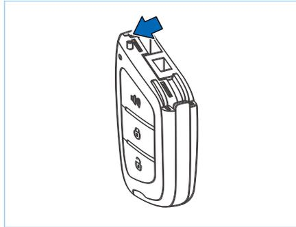
3. Снимите схемную плату.
