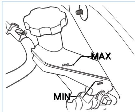
Тормозную жидкость в баке с тормозной жидкостью следует регулярно проверять. Уровень всегда должен находиться между отметками «MAX» и «MIN». Во время движения из-за износа и автоматической регулировки фрикционных дисков тормозов уровень жидкости немного снизится, что является нормальным явлением. Однако, если жидкость в баке значительно упадет или опустится ниже отметки «MIN» в течение короткого периода времени, возможно, тормозная
