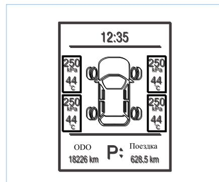
Интерфейс монитора давления / температуры в шинах: он может контролировать давление и температуру в шинах. Единица измерения давления в шинах - кПа, точность - 1 кПа. При получении недопустимого значения экран будет мигать с частотой 1 Гц с отображением -.- на экране. Единица измерения температуры шины - °С, точность - 1 °С. При получении недопустимого значения экран будет мигать с частотой 1 Гц, на экране будет отображаться -.
