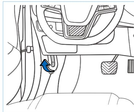
2. Вытяните руку внутрь переднего края капота двигателя и потяните предохранительный рычаг влево, чтобы поднять капот.
