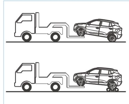
При буксировке за передние проушины задние колеса и ось должны быть в хорошем состоянии. Стояночный тормоз должен быть отпущен, а автомобиль надежно заблокирован.
