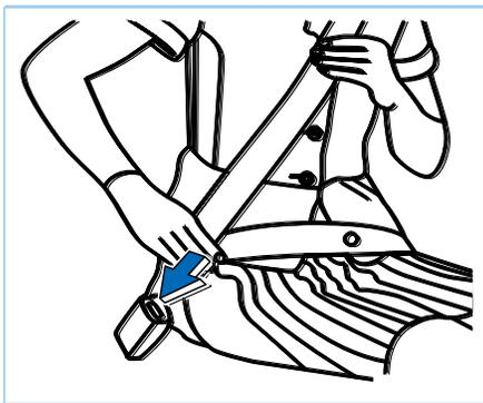
Чтобы пристегнуть ремень безопасности, вытяните ремень из натяжителя и вставьте пружинный болт в пряжку до тех пор,
