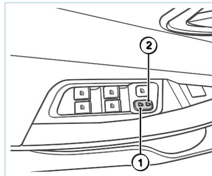
Кнопка управления дверным замком на стороне водителя позволяет управлять замком четырех дверей. Нажмите переднюю часть кнопки управления (часть 2), четыре двери заблокируются; нажмите на заднюю часть кнопки управления (часть 1), и четыре двери разблокируются.
