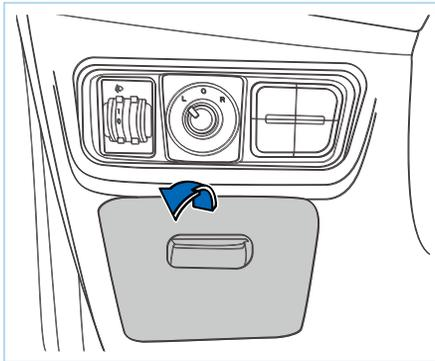
Каждая цепь оснащена предохранителем для предотвращения повреждения цепи вследствие короткого замыкания или перегрузки. Если новый предохранитель перегорит после замены через короткое время, это означает, что цепь неисправна. Обратитесь в официальный сервисный центр JAC, чтобы проверить и найти причину, а также отремонтировать систему и заменить предохранитель. При замене предохранителя используйте предохранитель той же мощности.
