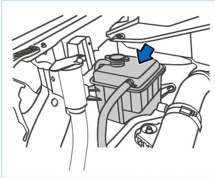
При перегреве двигателя запрещается использовать охлаждающую жидкость с концентрацией более 60% или менее 35%. Иначе можно повредить систему охлаждения двигателя. При добавлении или замене охлаждающей жидкости выбирайте подходящую концентрацию в соответствии со следующей таблицей:
