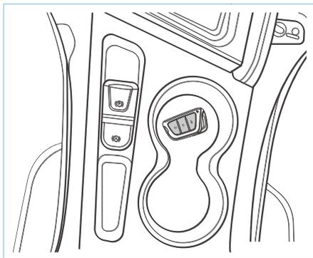
Запасная антенна находится на месте подстаканника за рычагом переключения на вспомогательной приборной панели. При низкой мощности, поместите смарт-ключ в это положение, тогда антенна распознает ключ по индукции приближения. Нажмите на педаль сцепления (для ручной модели) или педали тормоза (для автоматической модели). После того, как
