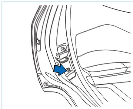
Две задние двери автомобиля оборудованы замками для безопасности детей. Функция блокировки для безопасности детей заключается в том, чтобы не дать пассажирам (особенно детям) потянуть за ручку внутренней двери и случайно открыть дверь внутри автомобиля, что может привести к несчастному случаю. Рекомендуется использовать данное устройство, при нахождении детей на заднем сиденье.
