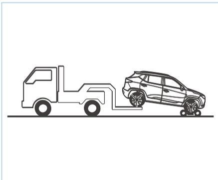
Когда автомобиль буксируется за задние проушины, поместите тяговую тележку под переднее колесо и надежно заблокируйте ее.
