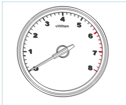
Тахометр показывает обороты двигателя в минуту, измеряемые в об/мин. Двигатель более подвержен износу и потребляет больше топлива, если во время движения частота вращения двигателя слишком высока. В большинстве случаев двигатели с низкими оборотами более экономичны.
