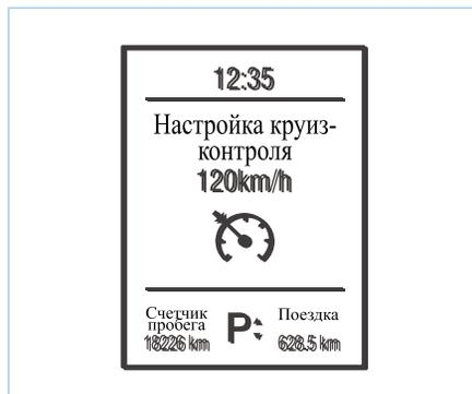
Скорость круиз-контроля отображает текущую скорость круиз-контроля автомобиля, установленную водителем. Крейсерская скорость может быть установлена переключателем круиза. Если круизная функция не активирована, на экране будет отображаться --- км / ч.
