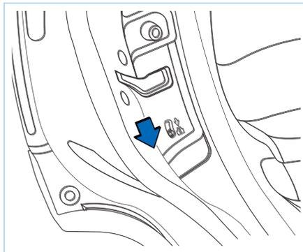
При установке блокировки предохранительного приспособления для детей блокировка на заднем крае двери должна быть опущена в положение перед закрытием двери. На этом этапе дверь можно открыть, только потянув за внешнюю ручку снаружи двери.
