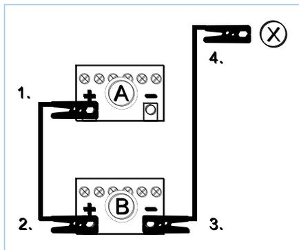
**При запуске от внешнего источника подключите соединительные кабели в соответствии со следующими инструкциями:**
