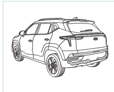
Если датчик радара заднего хода заморожен, в системе радара заднего хода может быть неисправен сигнал тревоги.
