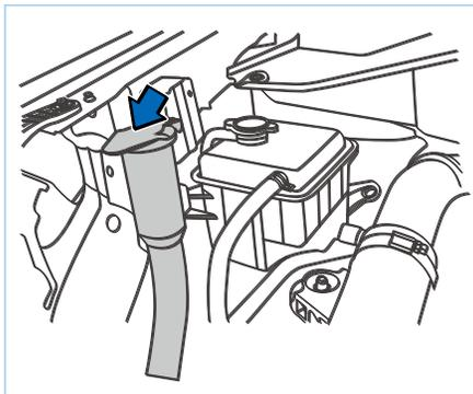
Откройте крышку бака для очищающей жидкости (находится в моторном отсеке) для заполнения. Рекомендуется, чтобы уровень жидкости был выше половины после заполнения. В холодную погоду запрещено заправлять более трех четвертей всех инъекций. Моющий раствор замерзает и набухает при низкой температуре. Если бак переполнен, очищающая жидкость не имеет пространства для расширения и может повредить бак для очищающей жидкости.
