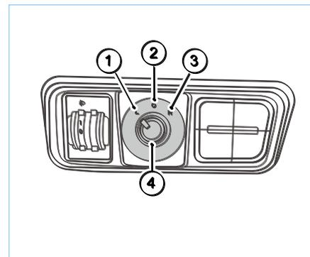
1. Левый: Выберите эту передачу, чтобы отрегулировать положение левого наружного зеркала заднего вида.
