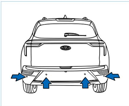
Радар заднего хода основан на принципе ультразвукового измерения расстояния от радарного датчика для определения наличия препятствий перед автомобилем и позади него, а также для указания расстояния до ближайшего препятствия.
