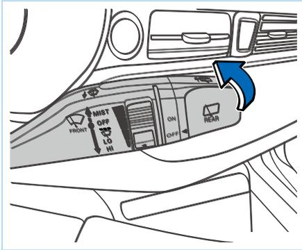
Поверните ручку управления стеклоочистителями по часовой стрелке в положение ON, чтобы включить задний стеклоочиститель.
