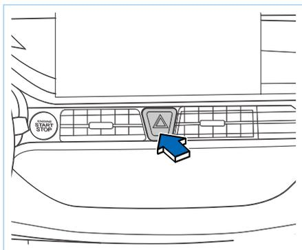
На выключателе лампы аварийной сигнализации есть треугольная метка, как показано на рисунке.
