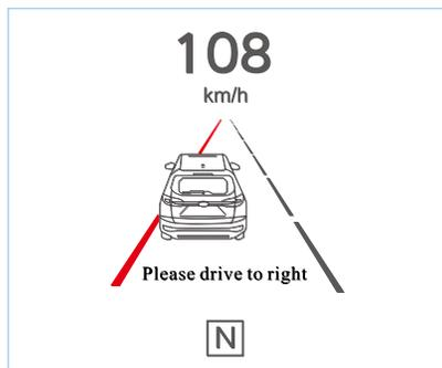
Интерфейс предупреждений комбинированного приборного модуля показан на рисунке выше (автомобиль отклоняется от левой полосы движения). Когда транспортное средство отклоняется от полосы движения, обнаруженной системой предупреждения о выезде с полосы движения, комбинированный приборный модуль показывает интерфейс предупреждения и посылает звуковой сигнал предупреждения о выезде с полосы движения, причем частота звука составляет 2 раза в секунду.
