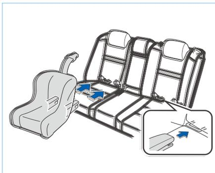
3. Сдвиньте механизм блокировки детского кресла в нижнюю точку крепления, чтобы убедиться, что два механизма крепления ISOFIX зафиксированы должным образом.
