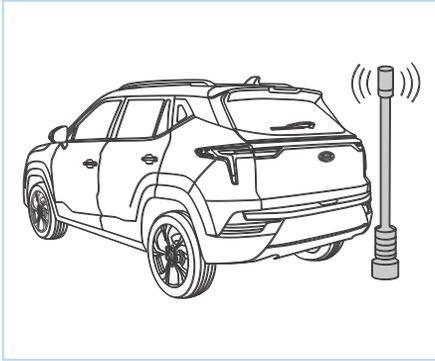
Если автомобиль оборудован высокочастотным радиоприемником или антенной, или если поблизости используется высокочастотные радиоприемник или антенна, в системе заднего хода может возникать сбой сигнализации.
