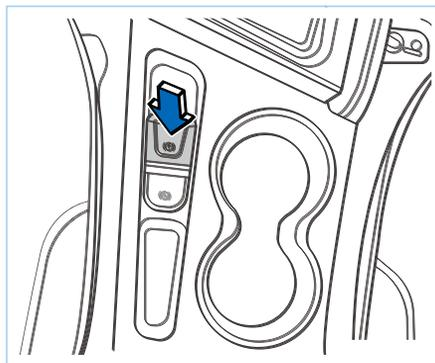
Ручная парковка: когда ключ зажигания находится в положении ON, нажмите один раз выключатель EPB, двигатель EPB произведет парковку. Между тем на приборе загорится красный индикатор парковки.
