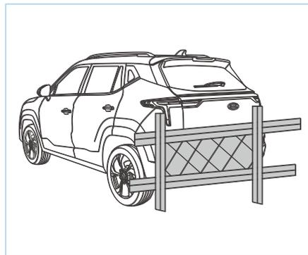
Реверсивный радарный датчик не может обнаружить железную проволоку, кабель, блочную сетку и другие сети.
