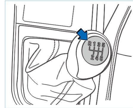
Положение каждой передачи указано на рукоятке переключения передач механической коробки передач.
