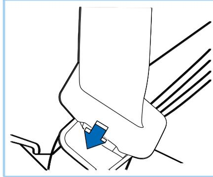
Нажмите кнопку фиксатора в кольце пряжки, чтобы отстегнуть ремень безопасности. Когда ремень безопасности отстегнут, он автоматически втягивается в коробку сжатия. В противном случае проверьте, не перекручен ли ремень безопасности, и повторите попытку.
