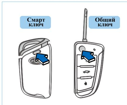
Смарт-ключ: для извлечения механического ключа, нажмите кнопку разблокировки и извлеките ключ.
