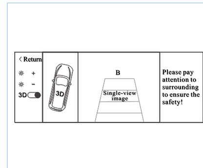
Когда отображается 3D-панорамный дисплей и рычаг переключения передач переведен на заднюю передачу, потяните за правый поворотный переключатель, чтобы переключить экран на 3D-панорамный дисплей правого заднего вида и одноканальное заднее видеоизображение плюс статическая вспомогательная линия для заднего хода, и автомобиль начнет движение вперед. Когда передача заднего хода отключена, экран возвращается к предыдущему трехмерному панорамному изображению.
