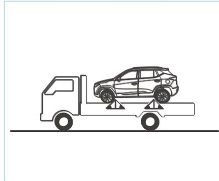
При буксировке с помощью грузовой платформы автомобиль должен быть надежно зафиксирован.
