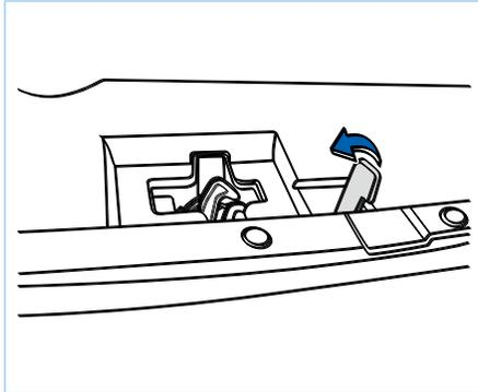
3. Поднимите капот двигателя в максимальное положение и подоприте тягу стойки.
