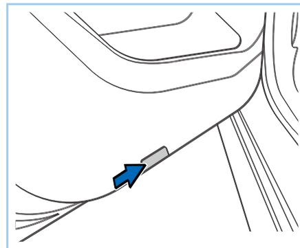
При открытии любой двери соответствующая лампа освещения логотипа будет освещаться. Лампа погаснет после закрытия двери.
