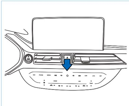
Оборудование А / С может нагревать, охлаждать и осушать воздух в автомобиле. Когда окна и подвижный световой люк закрыты, оборудование А / С работает с максимальной эффективностью. Вентиляция может ускорить охлаждение за счет накопления тепла в автомобиле. При использовании кондиционера для
