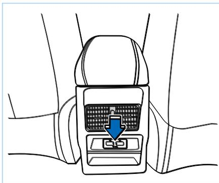
На вашем автомобиле установлен разъем питания. Этот разъем может подавать питание, когда ключ зажигания находится в положении ACC или в положении ON. В эту розетку можно вставить дополнительное электрическое устройство. Поднимите крышку перед использованием розетки. При не использовании, убедитесь что вы опустили крышку гнезда. Устройство можно заряжать после того, как задний USB-интерфейс для зарядки подключен к зарядному кабелю. Зарядный
