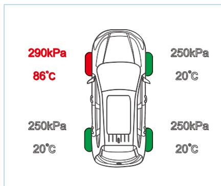
давления в шинах отображается белым цветом, и в это время интерфейс показывает, что давление в шинах водителя в норме.
