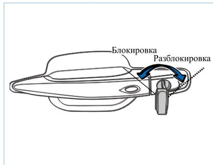
Когда дверь запирается на ключ снаружи автомобиля, четыре двери блокируются как после закрытия ключем и повернув его против часовой стрелки.
