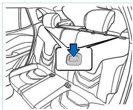
На спинке установлена кнопка разблокировки, а спинку можно разблокировать, нажав на кнопку, и ее можно сложить вперед после разблокировки.
