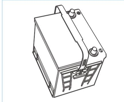
Ваш автомобиль оснащен необслуживаемым аккумулятором. Если необходимо заменить аккумулятор на новый, его номер должен совпадать с номером детали на этикетке оригинального аккумулятора. Обратитесь к обзору моторного отсека для определения расположения аккумулятора.
