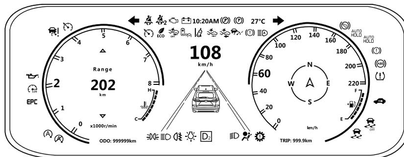
Интерфейс прибора зависит от модели вашего автомобиля, в данном руководстве будет описан Интерфейс-А.
