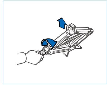
10. Установите домкрат на плоскую и надежную поверхность. Как показано на рисунке, поверните верхнюю часть домкрата по часовой стрелке, чтобы отрегулировать высоту домкрата.
