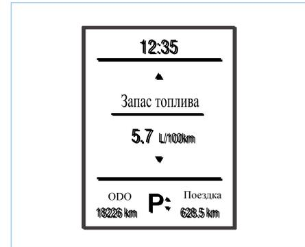
Расход топлива на коротких дистанциях показывает средний расход топлива за ездовой цикл в л/100 км. Каждый раз, когда остановка двигателя длится более 2 часов, расход топлива на коротких дистанциях автоматически сбрасывается. После очистки записи дальность движения менее 100 м отображается как --- L / 100 км. После пробега на 100 м отображается рассчитанный расход топлива на короткие расстояния.
