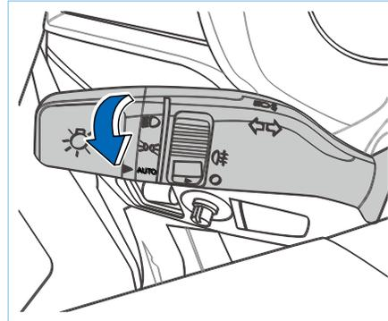
Когда поворотный переключатель установлен в положение AUTO, активируется система автоматического управления фарами, и лампа ближнего света, габаритный фонарь и фонарь автоматически включаются и выключаются в соответствии с освещением внешней среды. В темное время суток (например: автомобиль движется в сумерки,
