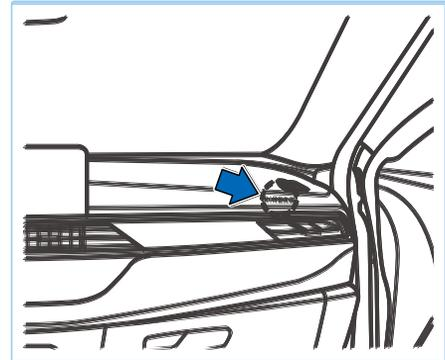
Ваш автомобиль оборудован системой пассивной безопасности (SRS) с надписью "AIRBAG" на крышке центрального клаксона на рулевом колесе и на передней панели переднего пассажирского сиденья. При столкновении, помимо защиты, обеспечиваемой ремнями безопасности, система SRS обеспечивает дополнительную защиту водителя и переднего пассажира.
