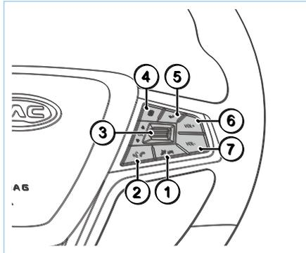
1. Функция телефона доступна только для моделей, оснащенных телефонами Bluetooth и системами распознавания голоса. При включенной голосовой системе, нажмите эту кнопку, чтобы выключить ее; если на телефоне имеется Bluetooth, а также во время разговора нажмите эту кнопку, чтобы завершить или отклонить вызов. Нажмите эту кнопку, чтобы отключить звук во время работы информационно-развлекательной системы.
