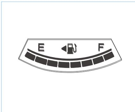
Указатель уровня топлива показывает оставшееся количество топлива в топливном баке. Верхний предел масла обозначен как F, а нижний предел обозначен как E.
