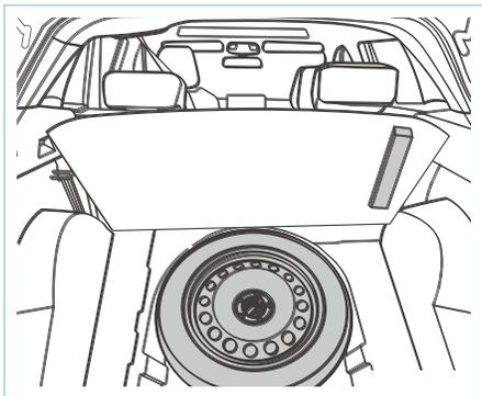
Запасное колесо закреплено в нижней части автомобиля под покрытием багажника, тяговый крюк и домкрат закреплены под запасным колесом, а на задней части покрытия багажника установлена треугольная предупреждающая табличка.
