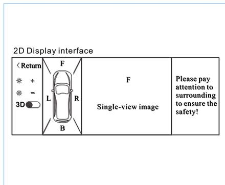
Отображение экрана переднего вида (в режиме разделенного экрана левая сторона - это экран панорамы, а правая сторона - одноканальное переднее видеоизображение плюс статическая вспомогательная линия).
