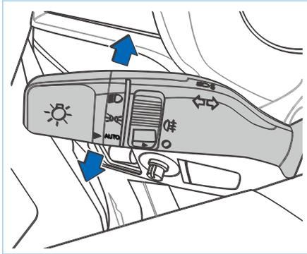
Лампа поворота работает только при включенном зажигании. Если транспортному средству необходимо повернуть налево, поверните джойстик освещения вниз; если нужно повернуть направо, поверните световой джойстик вверх. Соответствующий индикатор поворота на комбинированном приборе будет одновременно мигать. После осуществления поворота и
