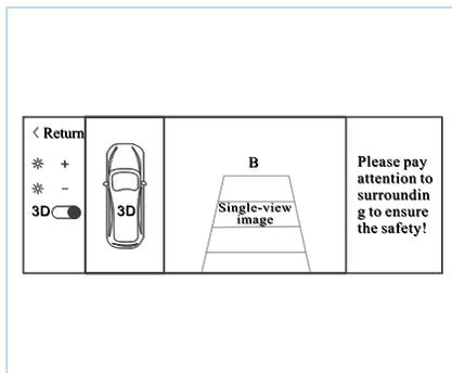
Когда отображается 3D-панорамный дисплей и рычаг переключения передач перемещается на заднюю передачу, экран переключается на 3D-панорамный дисплей заднего вида и одноканальное заднее видеоизображение плюс статическая вспомогательная линия для движения задним ходом, и весь автомобиль движется вперед. Когда передача заднего хода отключена, экран возвращается к предыдущему трехмерному панорамному изображению.
