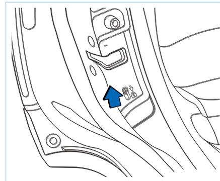
Если вы хотите разблокировать замок безопасности, сначала откройте дверь снаружи автомобиля и поверните замок для безопасности детей на заднем крае двери в обратное положение.
