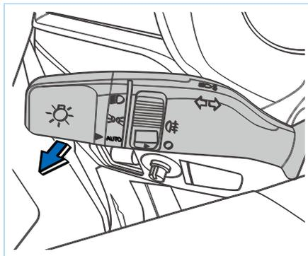
Чтобы лампа дальнего света мигала, осторожно потяните джойстик лампы в сторону водителя и отпустите его. Тем временем лампа дальнего света загорается, а затем гаснет. Даже если джойстик лампы находится в положении OFF, фара также может мигать. Если поднести джойстик лампы к стороне водителя, лампа дальнего света будет гореть все время, пока вы удерживаете джойстик.
